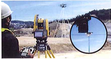
TSトラッキング UAS による測量イメージ
